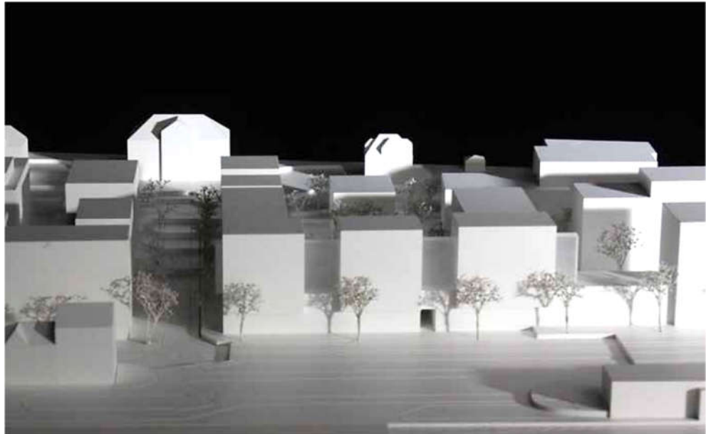
Abbildung 13 Raumwirkung in der Pestalozzistrasse und an der Kantonsschulstrasse: Das alte Schulhaus wird gerahmt, seine Beziehung zur Rapperswilerstrasse gestärkt. Vor der benachbarte Villa (mit Satteldach, rechts von der Bildmitte) öffnet sich eine Lücke in der Hofrand- bebauung, so dass vom Altbau aus der Blick nach Südwesten zum Licht und ins Grün fällt.
