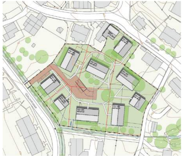
offene Bebauung mit Zeilen und Punktbauten
