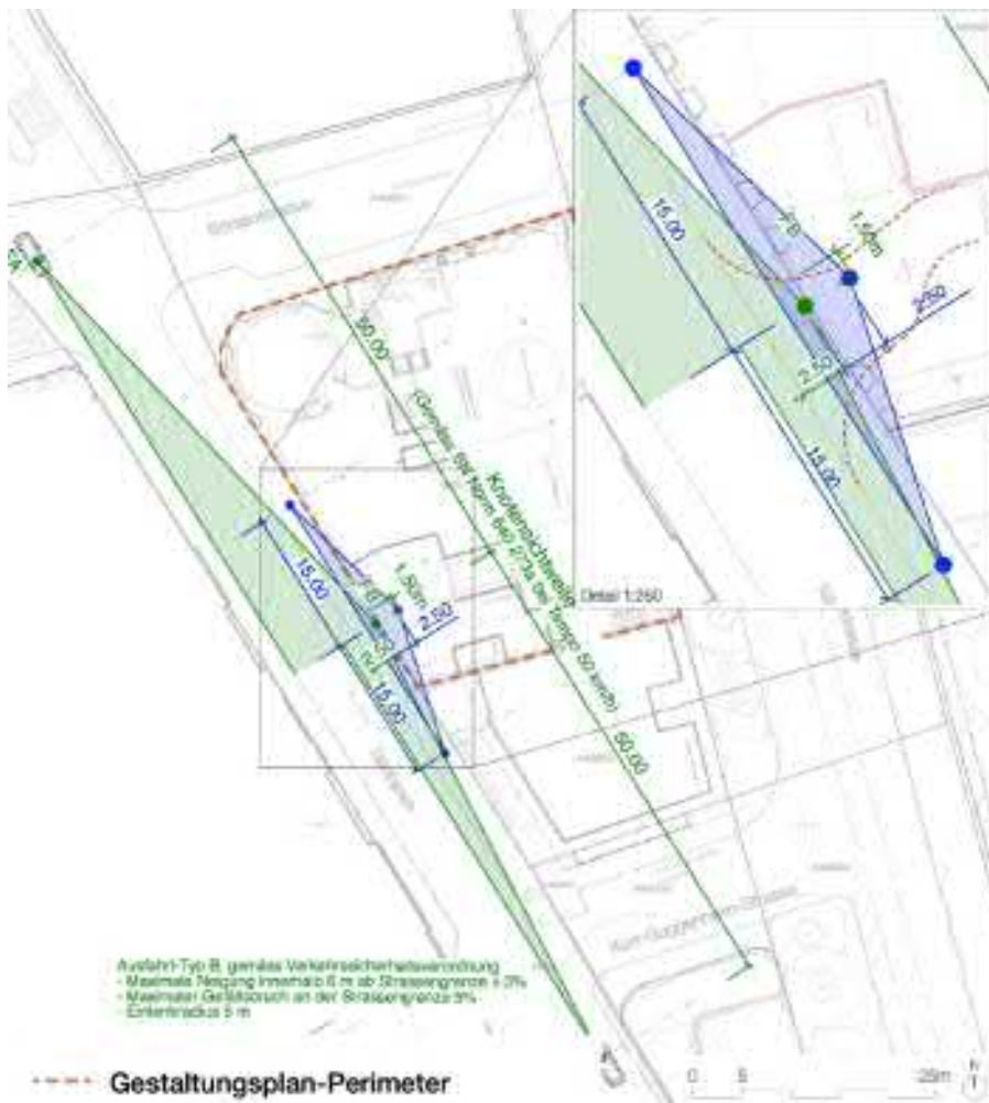
Abbildung 39 Knotensichtweite Anschlussknoten Talstrasse (Quelle: IBV Hüsler AG)
