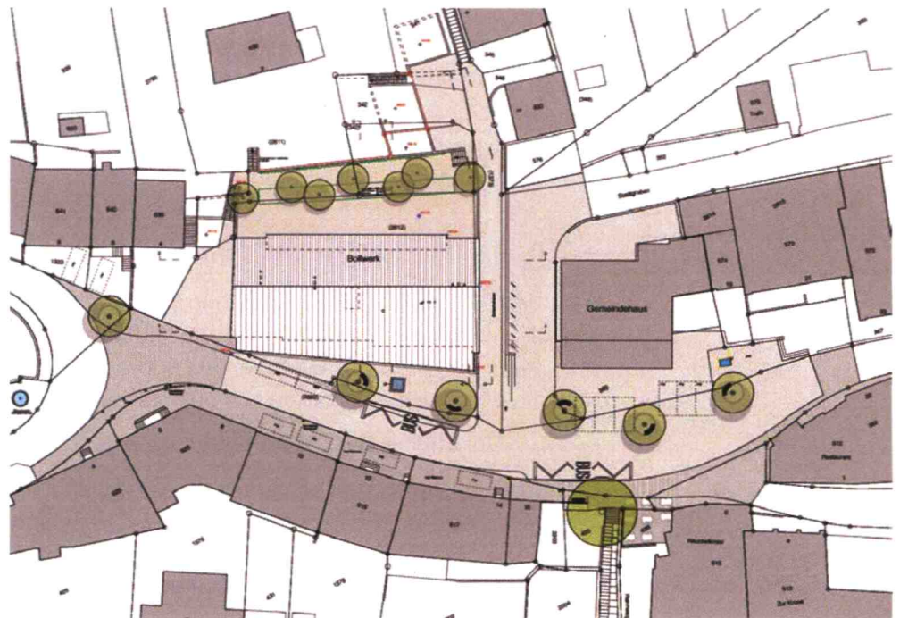
Abb. 6: Situationsplan Neubau Bollwerk mit Begegnungszone Obergass / Törlplatz
