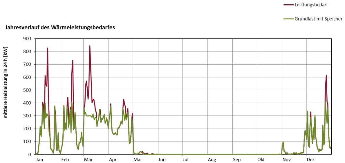
Abbildung 3: Jahresverlauf Wärmeleistungsbedarf, simuliert mit ProColor®
