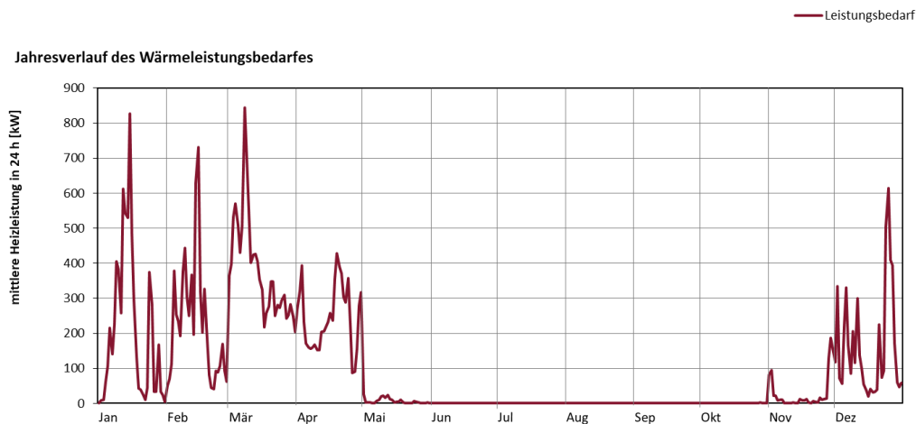
Abbildung 2: Jahresverlauf Wärmeleistungsbedarf Gewächshäuser simuliert mit ProColor®
