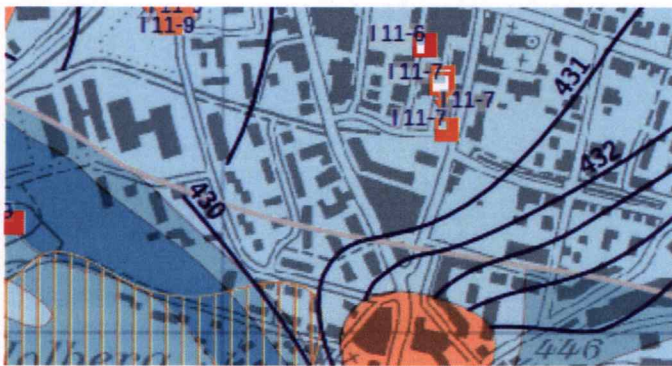
Abbildung 4: Ausschnitt Grundwasserkarte (Mittelwasserstand), Quelle: gis.zh.ch, 03.02.2015
