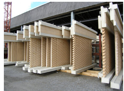
vorgefertigte Klinker-Fassadenelemente, Zentrum für Alterspsychiatrie St.Pirminsberg – Pfäfers SG, huggenbergerfries Architekten
