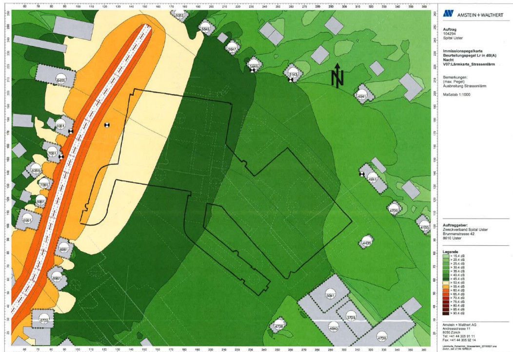
Abbildung 21: Immissionspegelkarte Strassenlärm Brunnenstrasse
