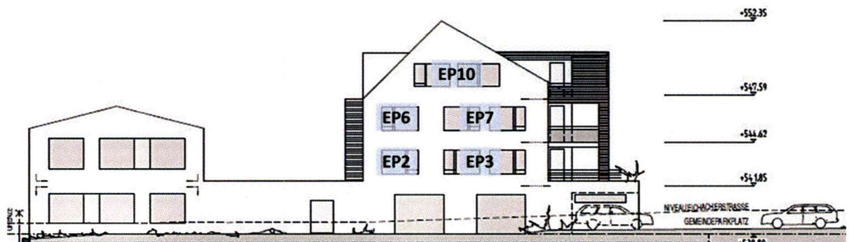
Abb. 5: Empfangspunkte an der Westfassade (in Richtung Dorfstrasse) des geplanten Gebäudes
