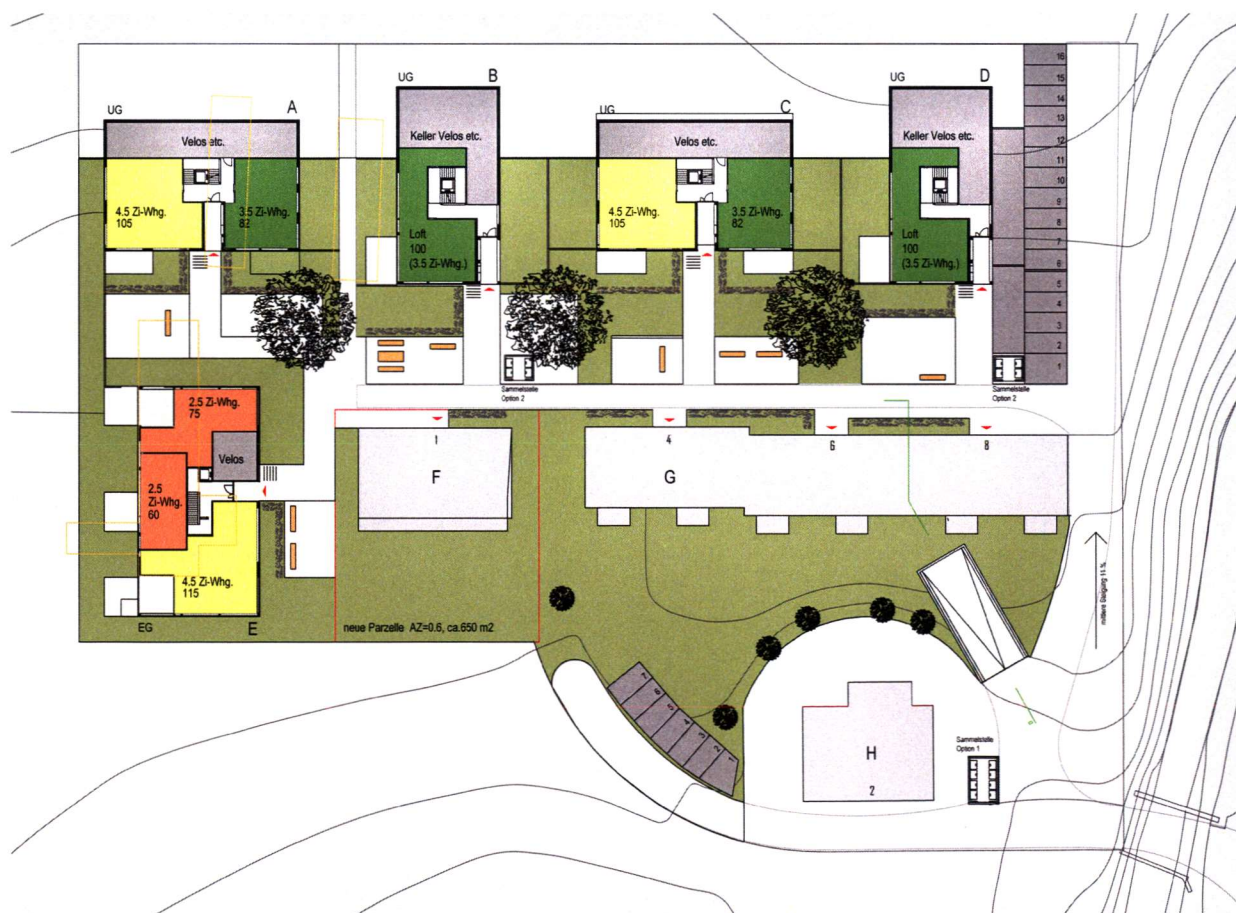
Situationsplan mit den Untergeschossen der Gebäude A-D und dem Erdgeschoss des Gebäudes E (Quelle: CH Architekten)
