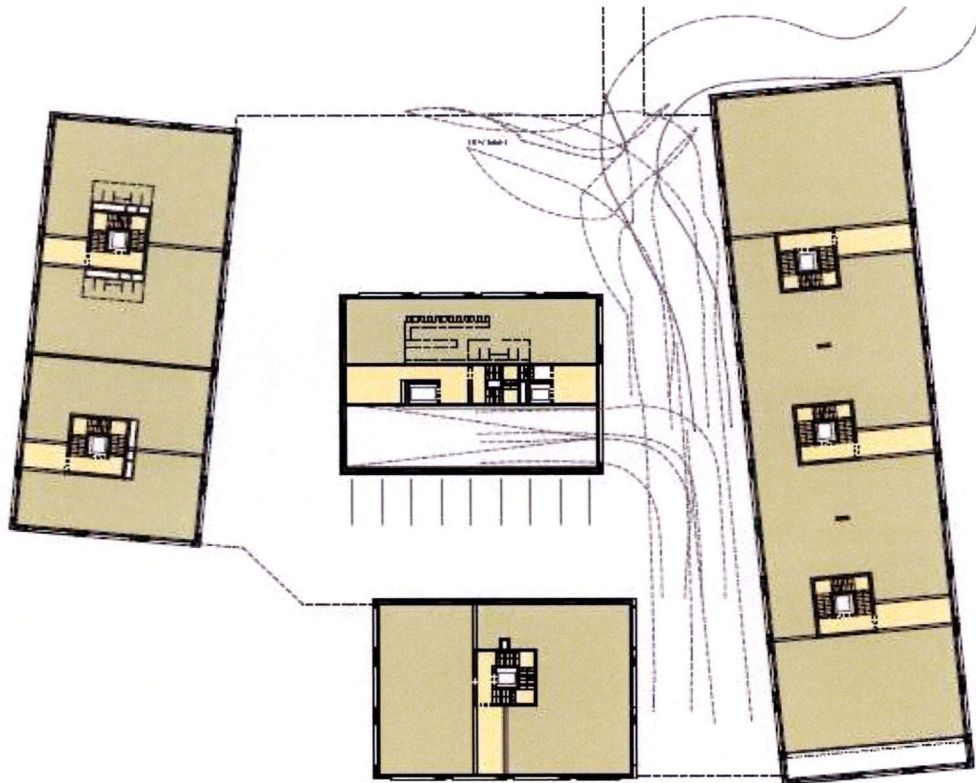
Abbildung 4: Zufahrtssituation der Tiefgarage und der Anlieferung
