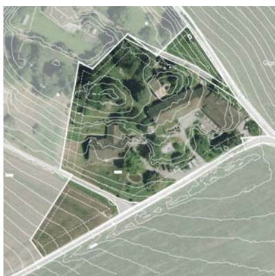
Orthophoto GIS mit photogrammetrischen Höhenlinien
