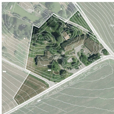
Orthophoto GIS mit photogrammetrischen Höhenlinien
