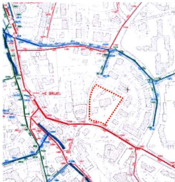
Abbildung 9: Übersichtsplan öffentliche Kanalisation (rot = Mischwasser; blau = Regenwasser)
