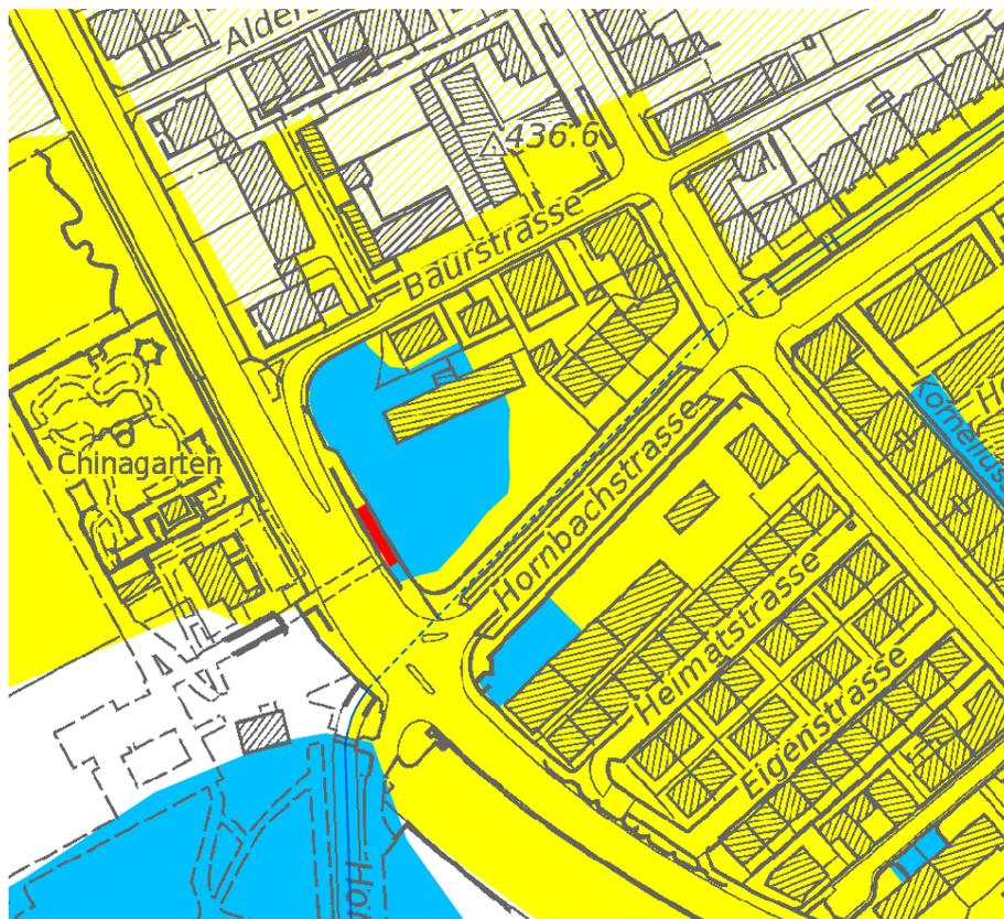
Abbildung 9: Ausschnitt Gefahrenkarte mit geringer (gelb), mittlerer (blau) und erheblicher Gefährdung (rot)
