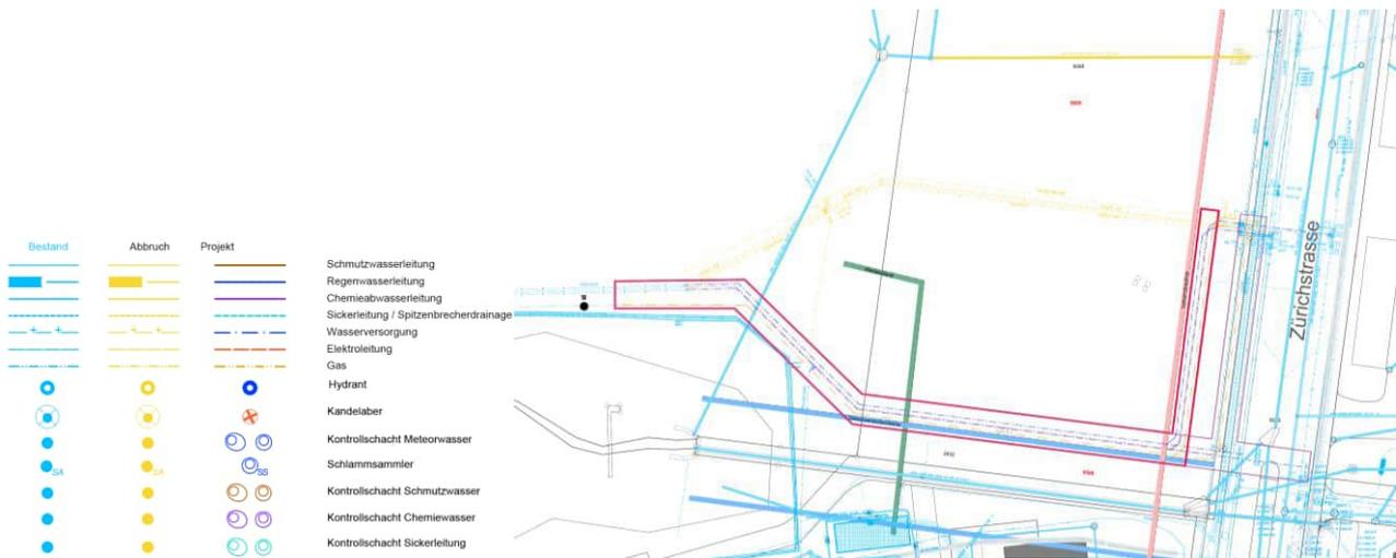
Abbildung 29: Geplanter Werkleitungskorridor (Suisseplan 2024)
