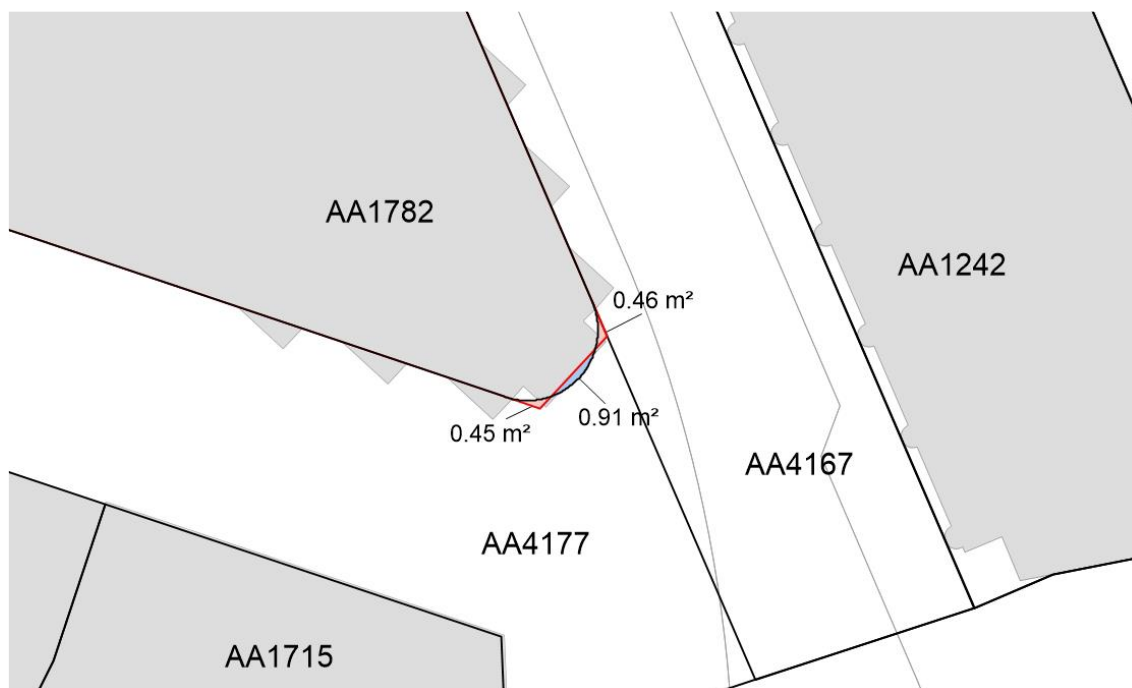
Abbildung 1: Detailausschnitt Änderung Parzelle geometrie und Abtauschflächen, rot: Tauschfläche AA4177 (Stadt) an AA1782, blau: Tauschfläche AA1782 an AA4177 (Stadt)
