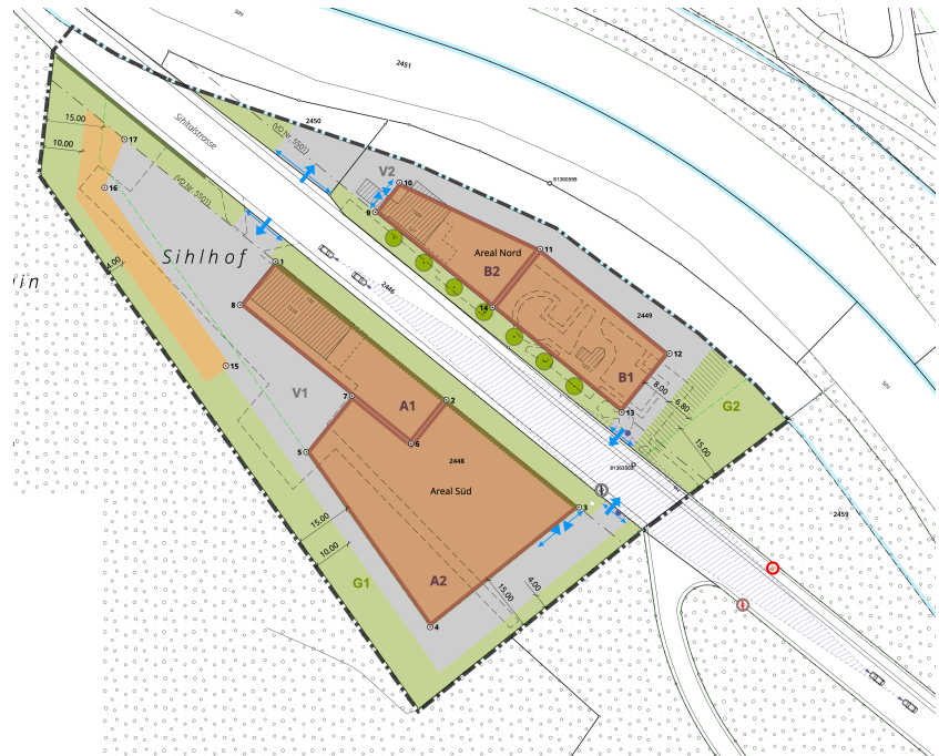
Abbildung privater Gestaltungsplan Sihlhof mit Baubereichen, Lagerflächen, Grünflächen und Erschliessungsflächen
