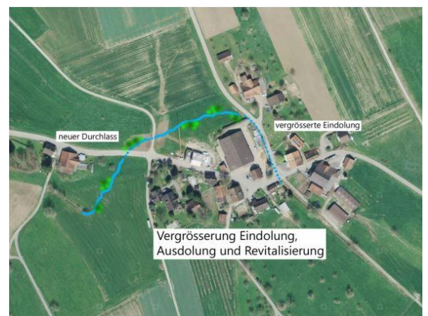
Abbildung 30: Bauliche Massnahmen Variante 2 im Bereich Baaregg
