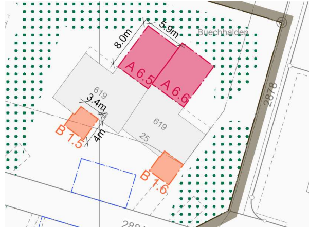
Abbildung 31: Vorgesehene Balkonerweiterung und zweigeschossige Anbaumöglichkeit bei Mehrfamilienhäusern
