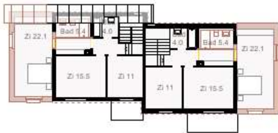
Abbildung 28: Grundriss mit seitlichem, zweigeschossigen Anbau eines Doppel-einfamilienhauses
