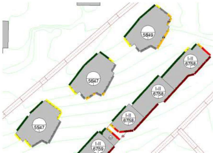
Abbildung 9: Situation Richtprojekt Nordost, Höhe Lärmriegel 7 m, die Grenzwerte sind am Tag und in der Nacht eingehalten
