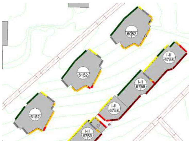
Abbildung 2: Situation Richtprojekt Nordost, Lärmriegel 2-geschossig, die Grenzwerte sind in der Nacht und am Tag teilweise überschritten
