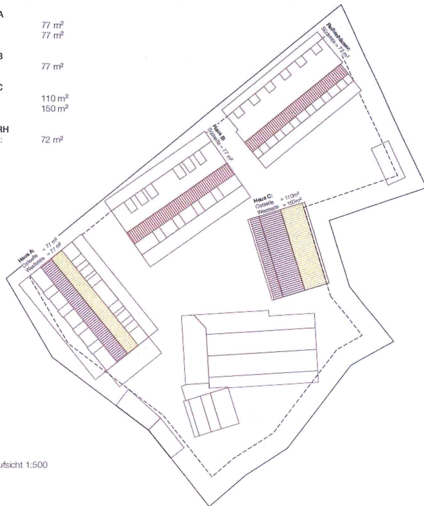
Abbildung 13: Nachweis möglicher Flächen für PV-Anlagen (Quelle: Baumberger & Stegmeier 2021)
