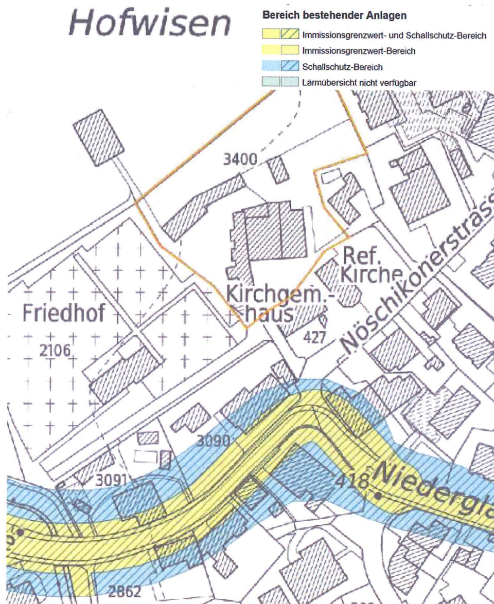
Abbildung 6: Lärmübersicht für Bauvorhaben (Quelle: GIS Kt. Zürich)
