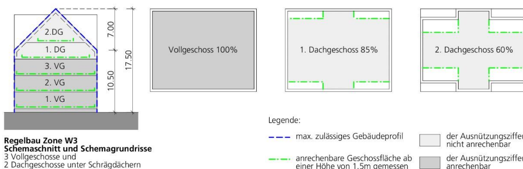
Abb. Nr. 17; Schemaschnitt und Schemagrundrisse mit Regelbauweise W3 (Gesamtnutzfläche 3'655 m 2 GNF)
