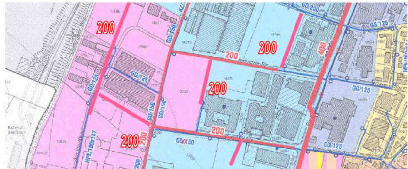
Geplante oder zu vergrössernde Wasserleitung
