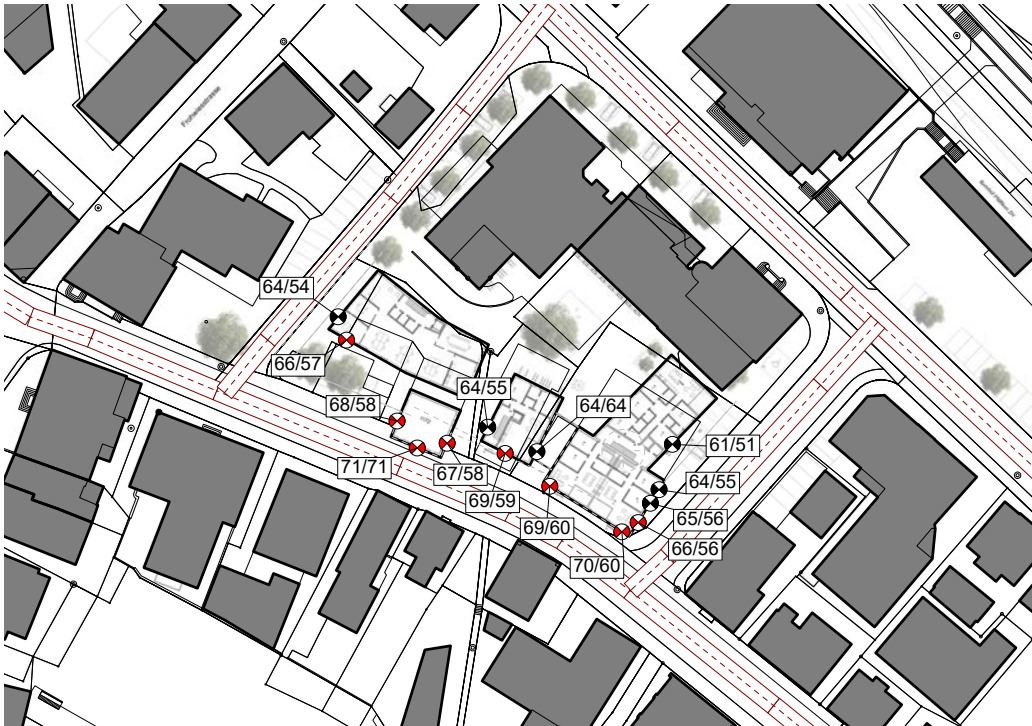
Immissionspegel Strassenverkehrslärm im 1.OG (4.5 m über Terrain). Die IGW werden bei Punkten mit roter Füllung überschritten. Modellierung: dBAkustik GmbH, 25.09.2019
