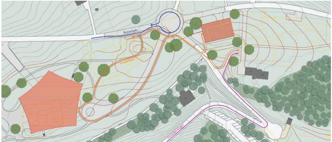
Abb. 24. Schema Erschließungskonzept mit Wendeschleife und Bushaltestelle (Projektidee, zu Händen AFV, Drittprojekt) und Parkierung (Hager AG 20.2.2023)
