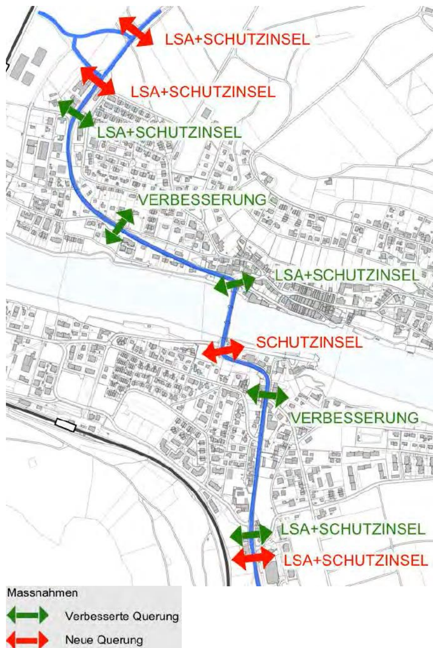
Abb. 24 Verbesserte Fussgängerquerungen, Ausschnitt Präsentation Betriebs- und Gestaltungskonzept Eglisau vom 8. April 2014 (Quelle: Amt für Verkehr, Kanton Zürich)
