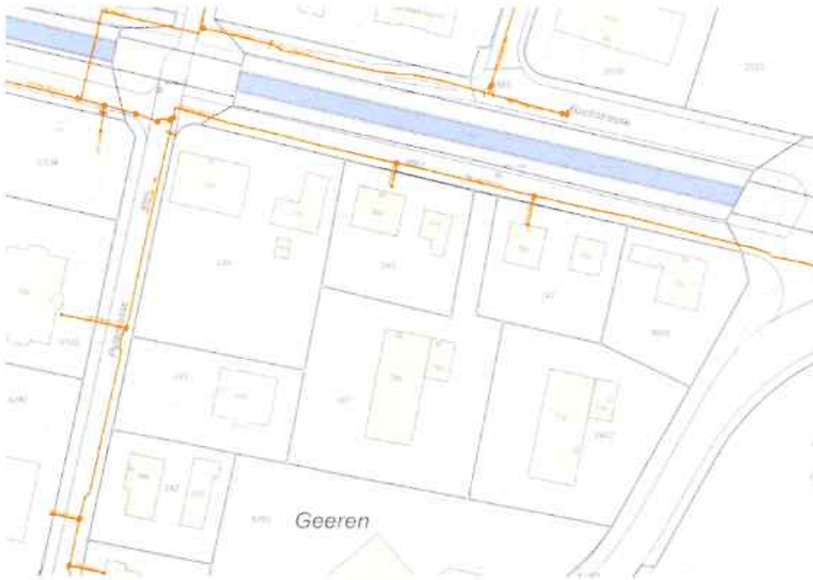
Abbildung 17 Gasleitungsversorgung, ibk, 13. Oktober 2016
